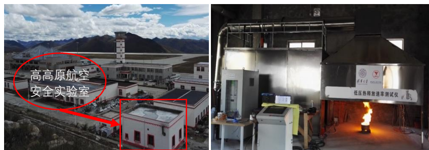
高高原航空安全实验室及全尺寸低压热释放速率测试平台
